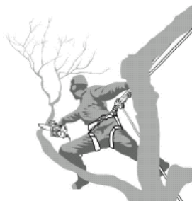
Fig. 1 – Caso d'uso della motosega con una sola mano
